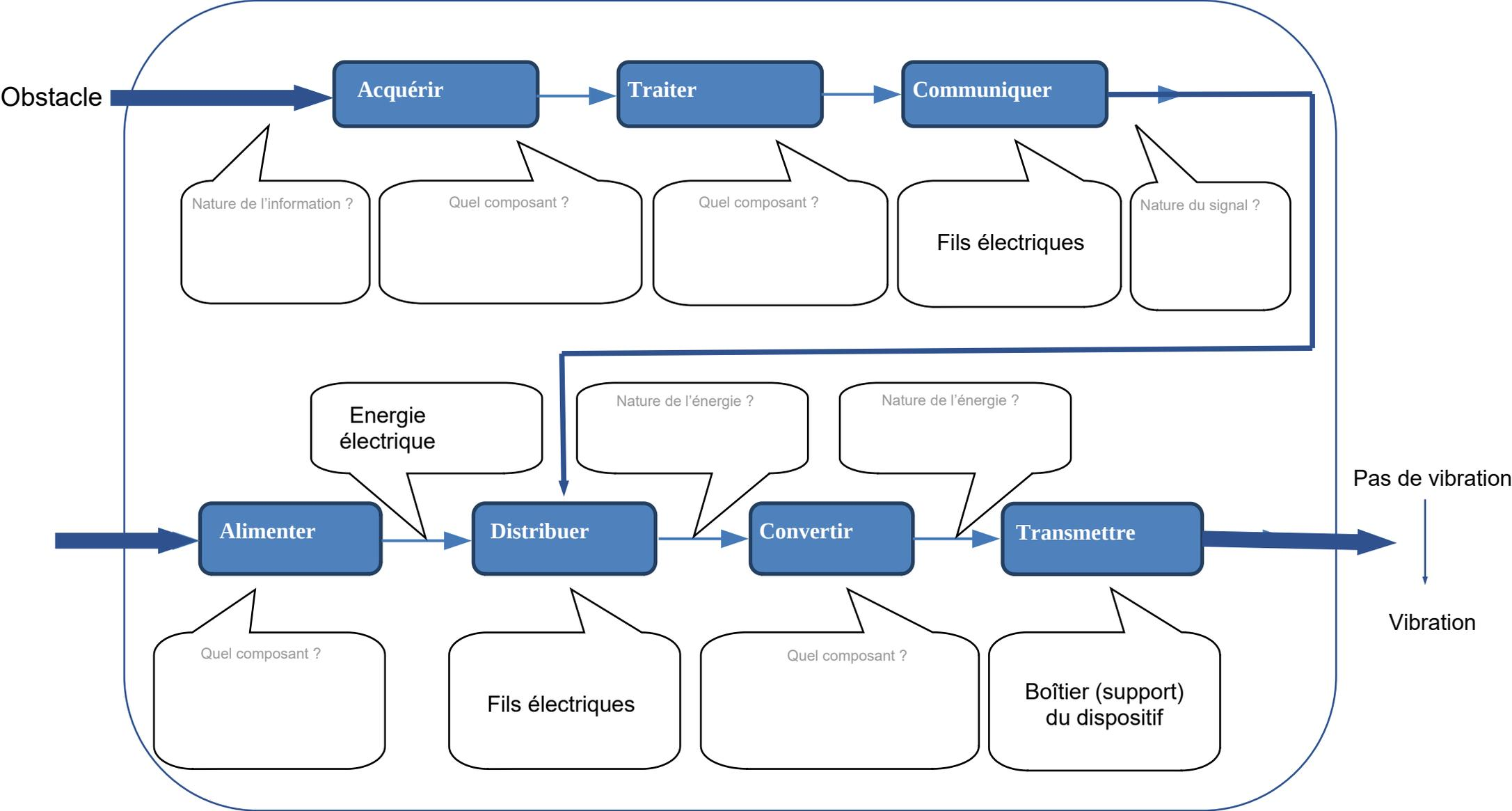
Compléter le diagramme SysML des blocs internes.
